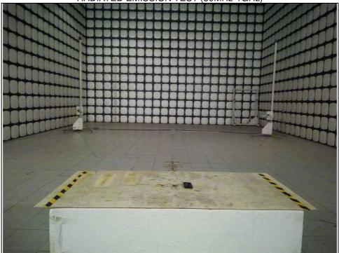
RADIATED EMISSION TEST (30MHz-1GHz)
