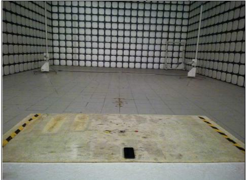
RADIATED EMISSION TEST (30MHz-1GHz)
